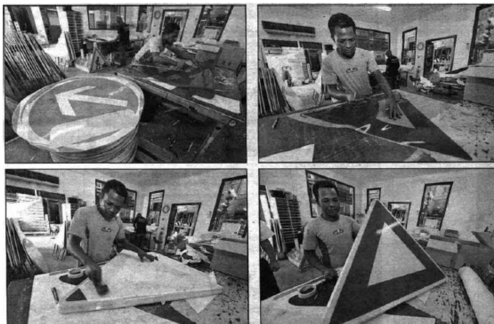
5. « Les ECF de couleur figurant les liserés ou les pictogrammes sont quant à eux posés manuellement », souligne Didier Mariani. Directement sur l'ECF transparent ornant désormais la plaque. Pour ce faire, un petit rouleau permet de doter les films colorés d'une pellicule de transfert. S'ensuit une application quasi semblable à celle du film rétro réfléchissant transparent, à la différence qu'elle est effectuée à la force du poignée.
